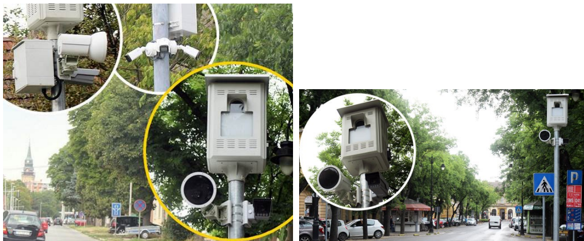
Слика 4.6. Изглед система за детектовање саобраћајног прекршаја - прекорачење дозвољене брзине кретања возила мерењем тренутне брзине кретања
